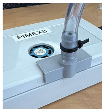
Figuur B2: PIMEX 2.0 stofsensor, buitenzijde. Links originele versie, rechts met aansluiting voor PAS-pomp
