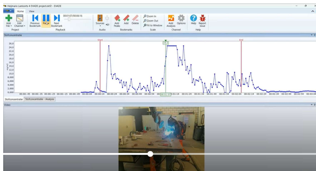
Figuur A2. Voorbeeld weergave EVADE (pilot stofblootstelling tijdens lassen). Grafiek boven de video geeft het verloop van de stofconcentratie gedurende de gehele opname; de verticale lijn in het midden boven de video geeft het moment in de tijd aan
